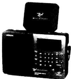
Een van de nieuwe ruimteontvangers, de satellietantenne is goed te herkennen.
